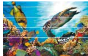
Intervallo/striature bianche (eccessiva velocità dei supporti)
